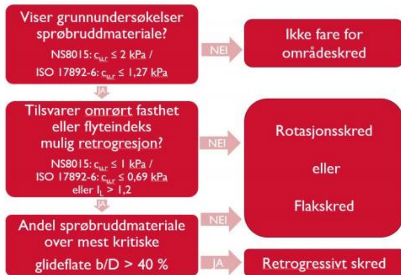
Figur 4.3 Flytskjema for vurdering av aktuell skredmekanisme
