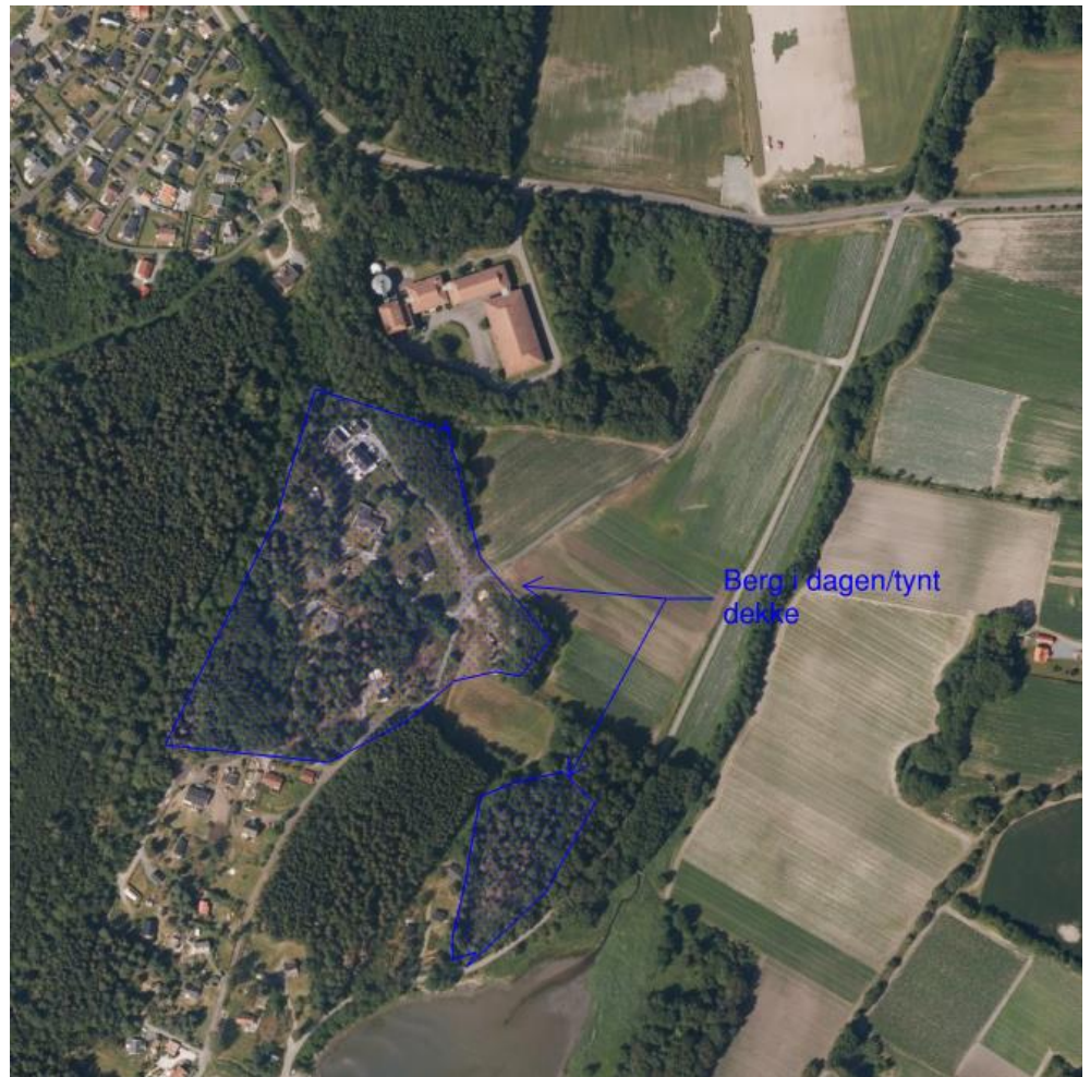
Figur 12: Berg i dagen/tynt dekke over berg observert ved befarings/flyfoto.
