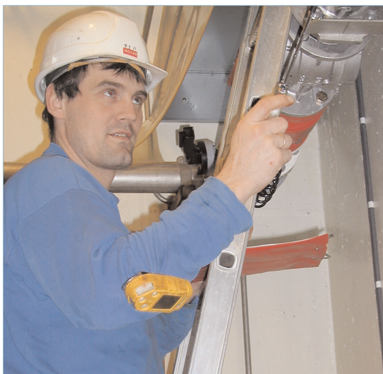
Driftsoperatør Per-Einar Pedersen måler metangasskonsentrasjon.
