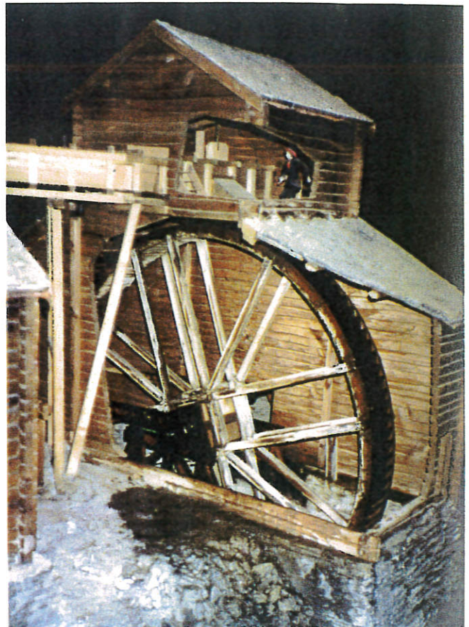
Slik ser et overfallshjul ut. Modell fra Røros.
